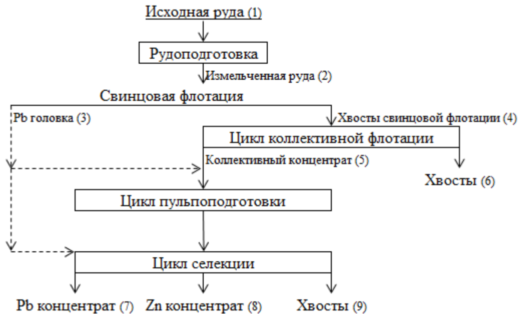
Рисунок 2.6.1 – Принципиальная схема обогащения сульфидной свинцово-цинковой руды
