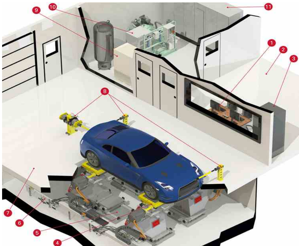
Рисунок 1.17 – Исследовательская лаборатория на основе стендового комплекса MTS Flat-Trac Handling Roadway (США):
