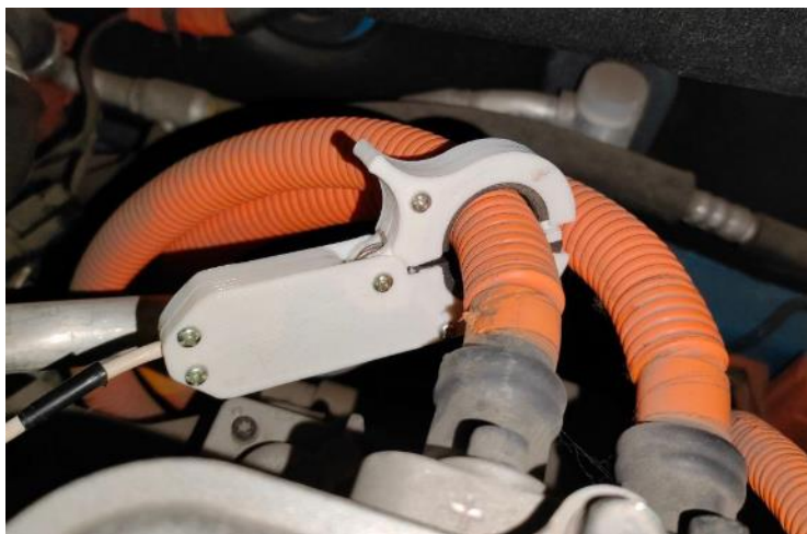
Рисунок 3.59 – Внешний вид датчика тока, закреплённого на высоковольтном проводе
