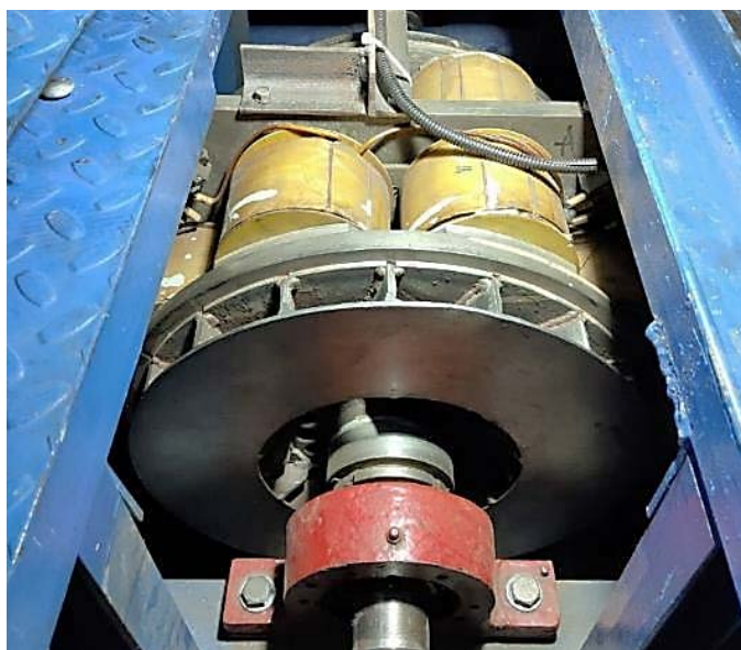
Рисунок 3.62 – Внешний вид электродинамического тормоза
