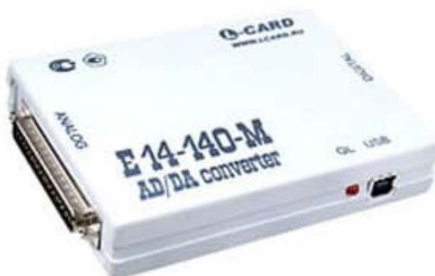
Рисунок 3.26 – Внешний вид АЦП-ЦАП «L-Card E-14-140» [199]
