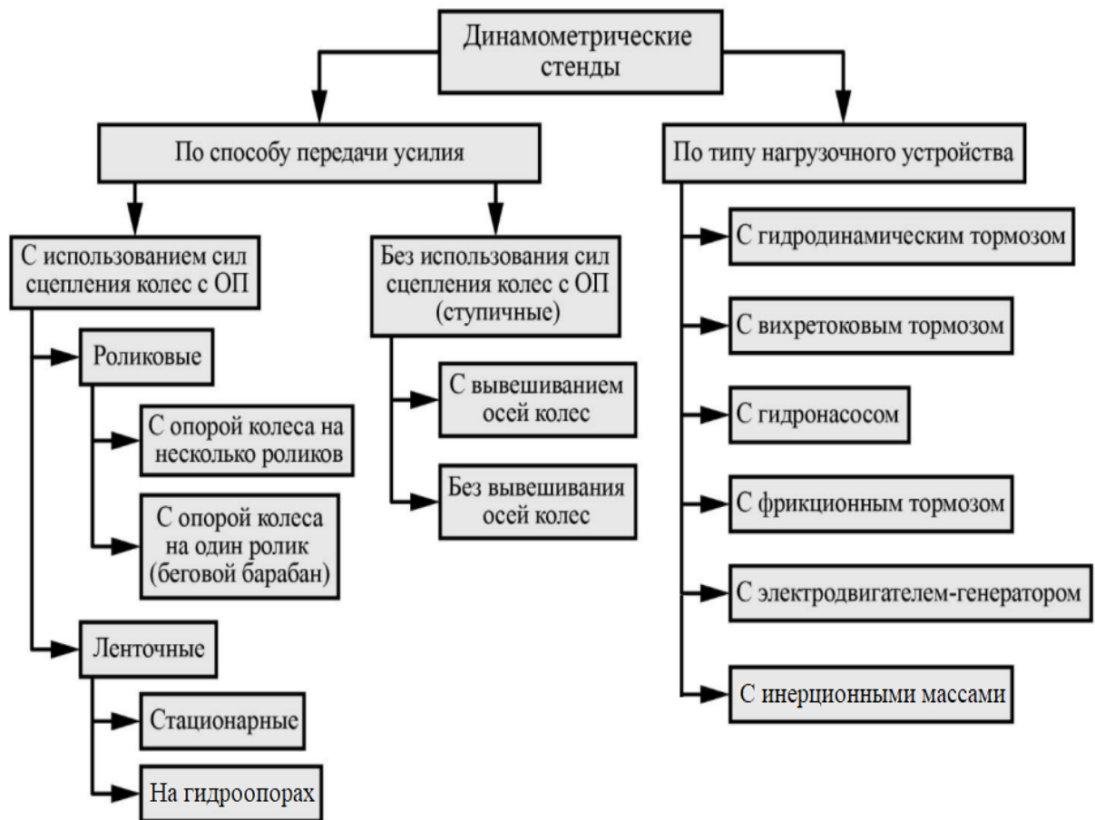
Рисунок 1.11 – Классификационная схема стендов, реализующих принцип обратимости движения [241].
