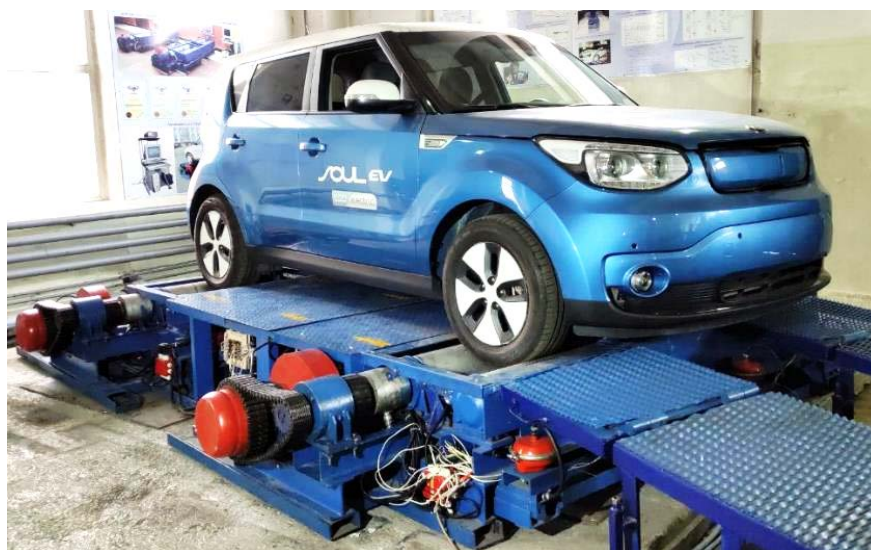
Рисунок 4.55 – Внешний вид исследовательского стендового комплекса ИРНТУ с установленным КТС Kia Soul EV
