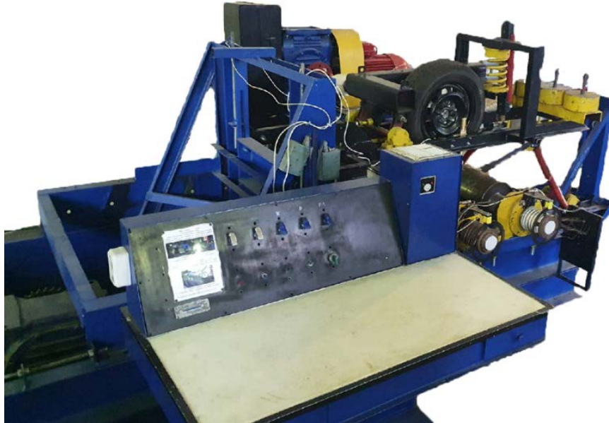
Рисунок 3.34 – Внешний вид комплекса для экспериментального исследования процессов взаимодействия эластичной шины в пятнах контакта с двумя беговыми барабанами стенда
