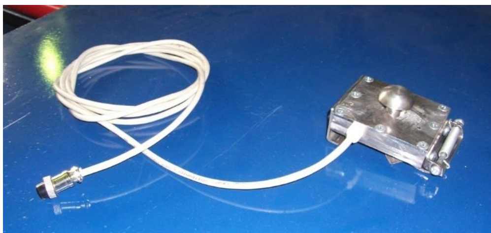
Рисунок 3.60 – Внешний вид датчика усилия уровня активации ОУ
