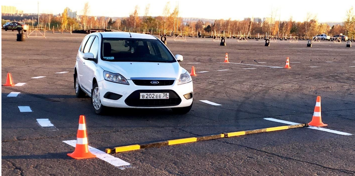
Рис. 1.11. Автомобиль движется по кругу в коридоре движения с единичной неровностью в процессе Контр-Тех-С амортизаторов [118].
