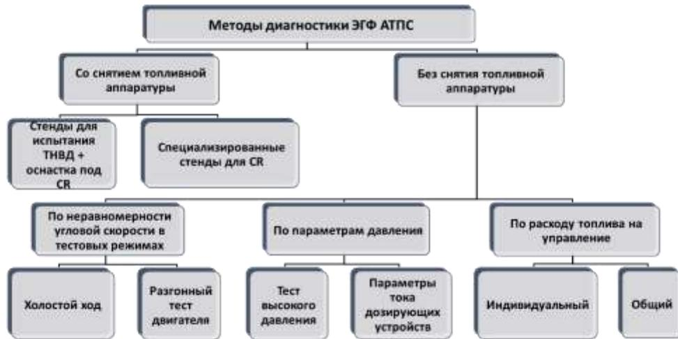
Рис. 1.12. Методы и средства для диагностики топливоподающих систем
