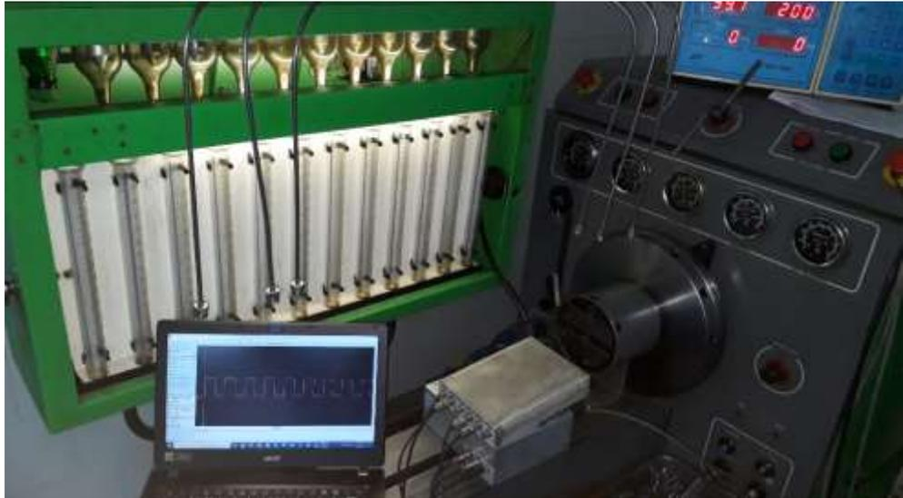
Рис. 3.18. Процесс тарировки системы измерения давления и расхода топлива на мензурочном стенде стенде Technopart 12 PSB.
