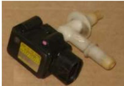
Рис. 3.15. Внешний вид датчика давления устройства диагностики.
