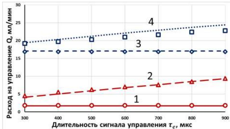
Рис. 4.14. Графики зависимости расхода топлива на управление ЭГФ, при давлении 40 МПа, с подключением и отключением управляющего сигнала (линии – расчёт, фигуры-маркеры – эксперимент);
