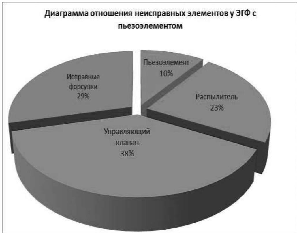
Рис. 1.8. Диаграмма отношения неисправных элементов ЭГФ с пьезоприводом [71].
