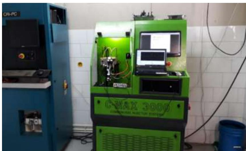
Рис. 3.4. Внешний вид стенда для испытания ЭГФ CR C-MAX 3000.
