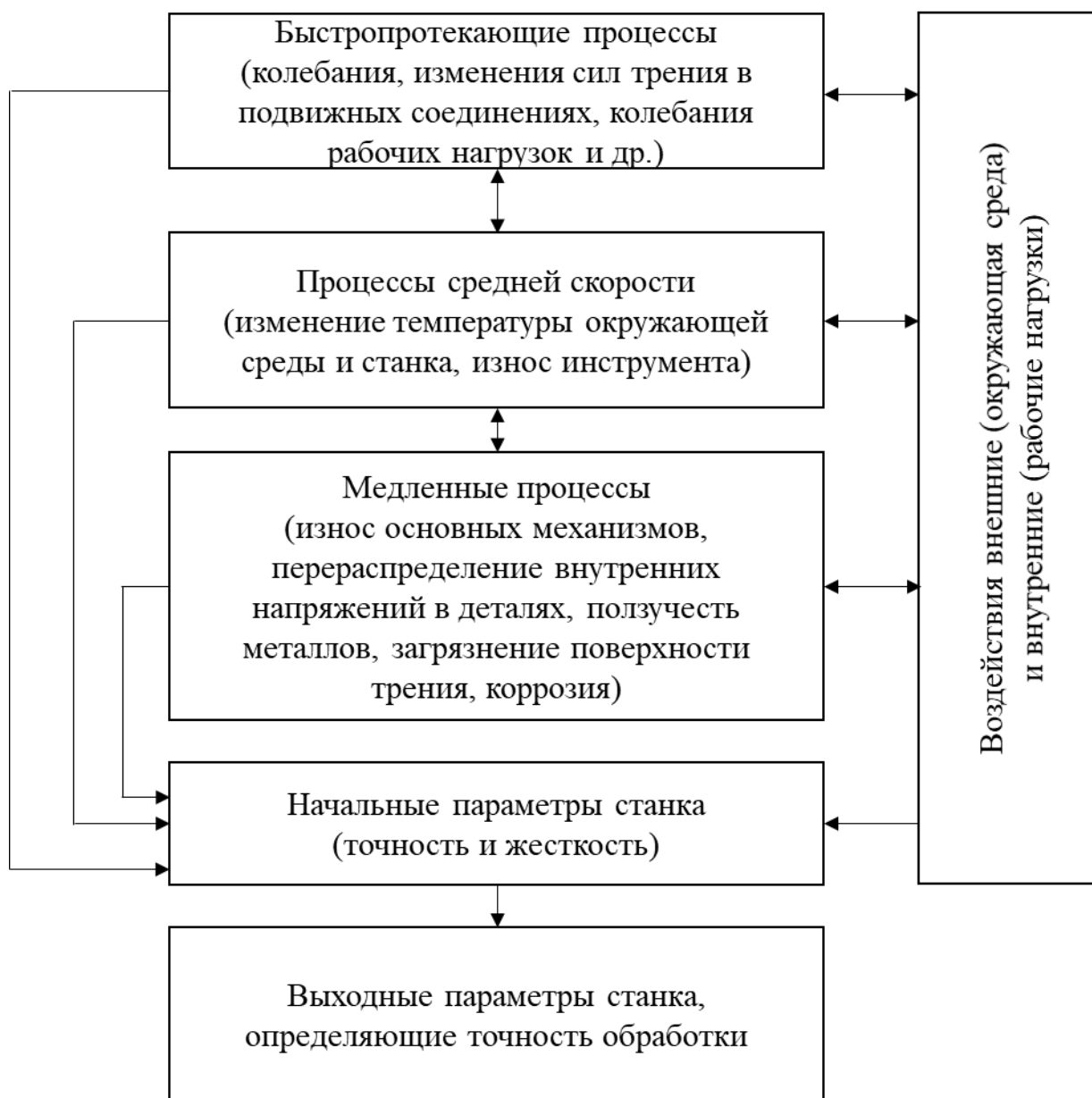
Рисунок 2.1 – Схема процессов в технологической системе
