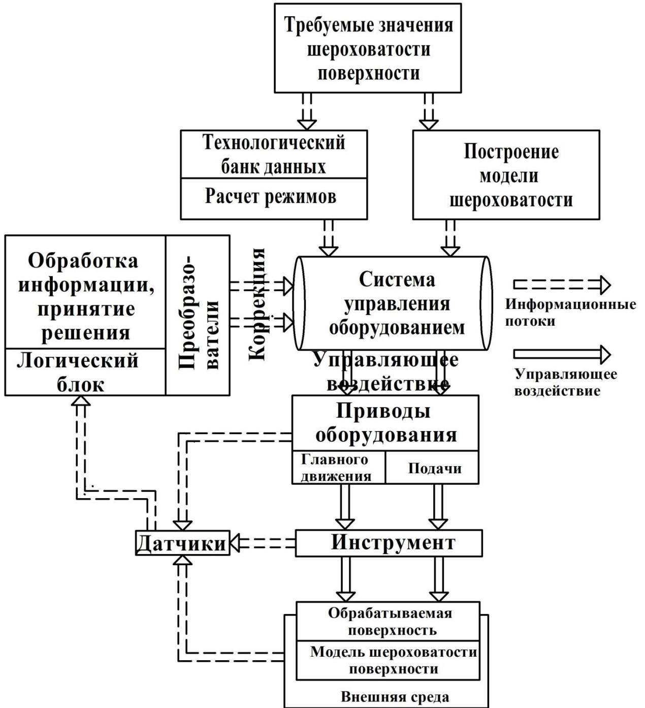
Рисунок 2.3 – Схема обеспечения заданных параметров качества обработки
