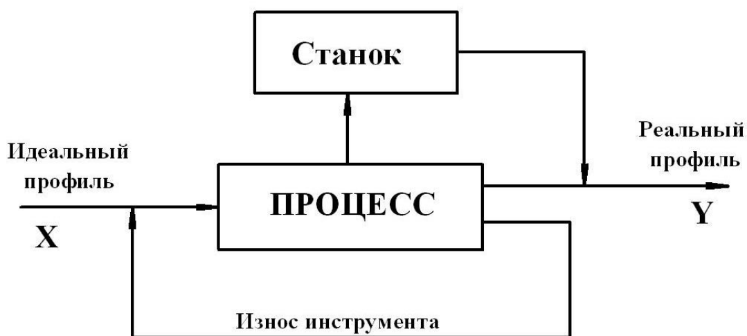
Рисунок 1.24 – Схема образования микропрофиля
