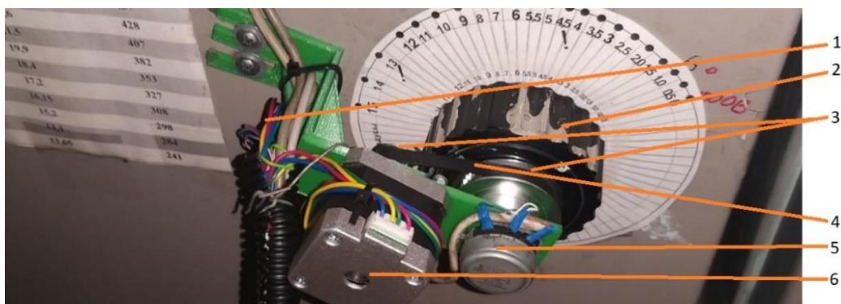
Рисунок 3.6 – Автоматическое устройство регулировки мощности ВЧ, где:
