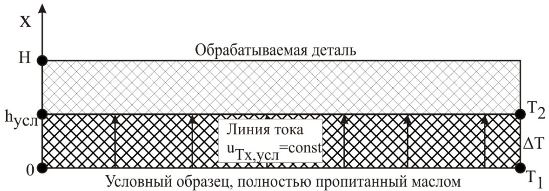
Рисунок 2.8 – Условный полиамидный образец, используемый при математическом моделировании
