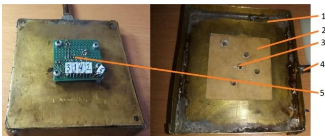
Рисунок 3.7 – Ванна-электрод со встроенными термодатчиками с рабочей областью 100x100 мм, где: 1 – ванна 100x100 мм; 2 – картонный изолятор; 3 – термистор; 4 – медная трубка для подачи наполнителя; 5 – плата термисторов
