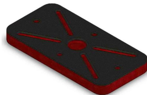
Рисунок 1.3 – Вкладыш (прокладка) опорного скользуна
