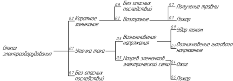
Рис. 2. «Дерево событий» при аварии в электропечи
