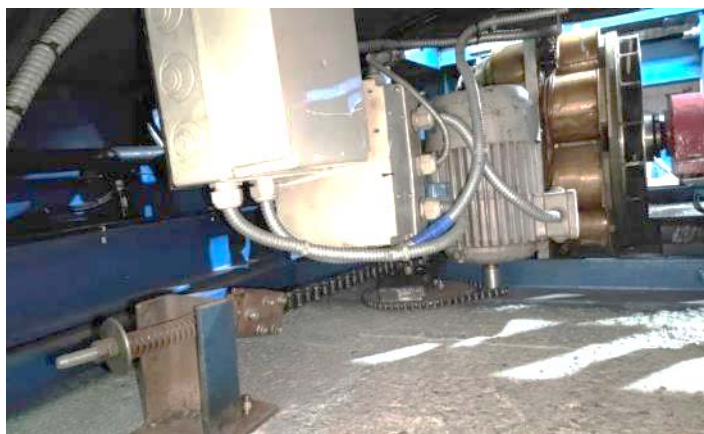
Рис. 39 – Внешний вид электродвигателя механизма поворота стенда и частотного преобразователя
