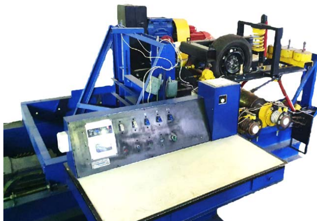
Рис. 18 – Внешний вид комплекса для экспериментального исследования процессов взаимодействия эластичной шины в пятнах контакта с двумя беговыми барабанами стенда
