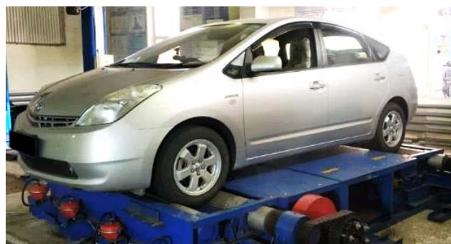
Рис. 19 – Внешний вид гибридного полноопорного стэнда ИРНТУ с установленным автомобилем Toyota Prius XW20
