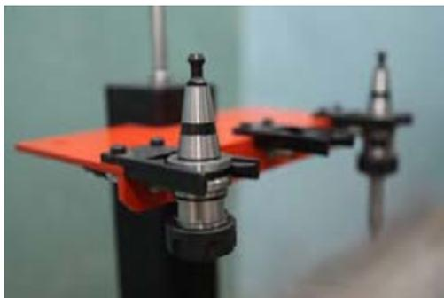
Рис. 7. Инструментальный магазин
