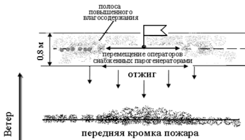
Рис.12. Технологическая схема 1 косвенного тушения лесного пожара при помощи переохлажденного водяного пара
