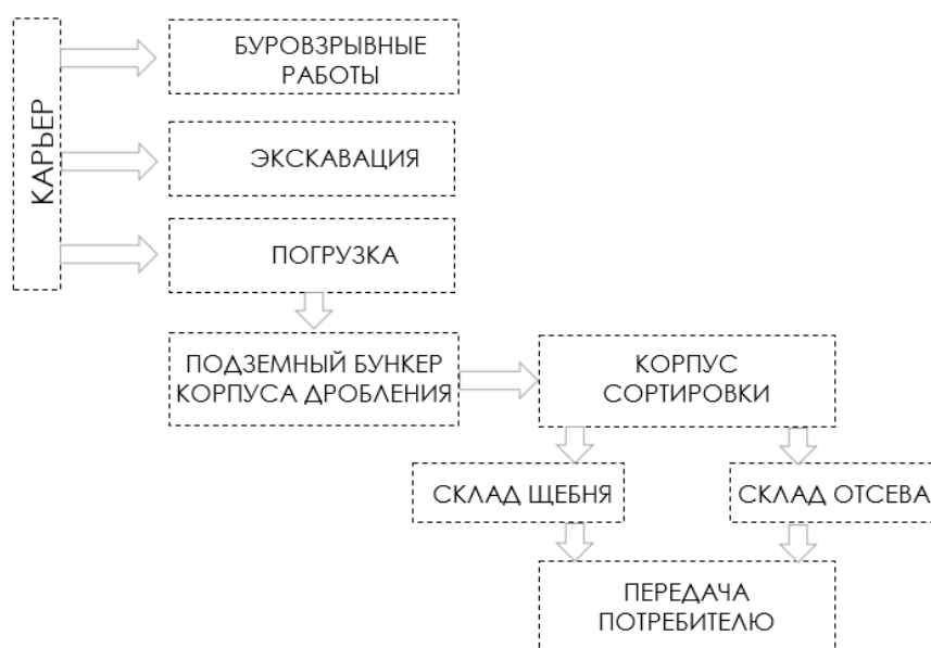
Рисунок 2.12 – Типовая схема добычи и переработки облицовочных и поделочных камней
