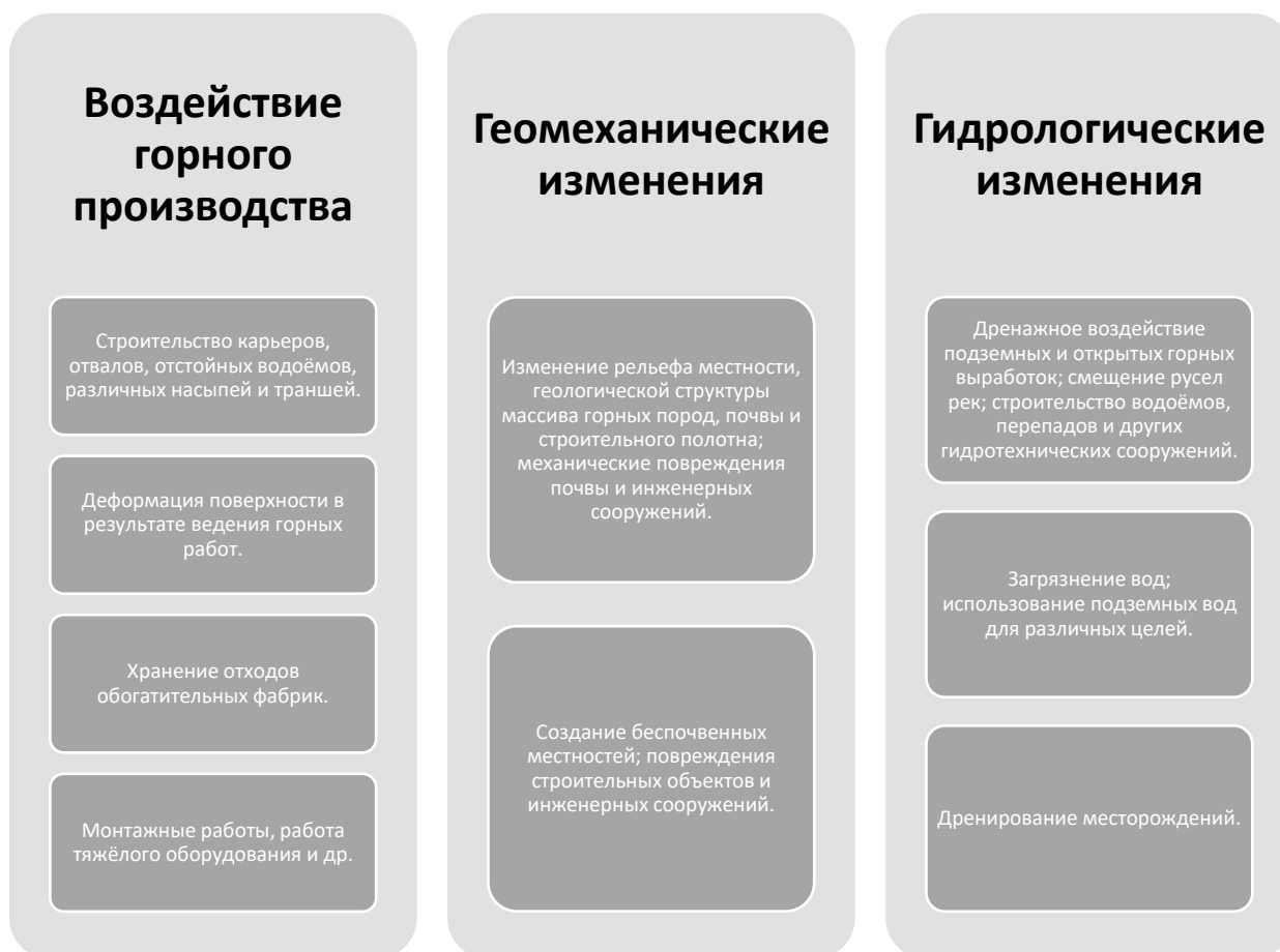
Рисунок 1.1 – Воздействие горного производства на окружающую среду с учетом геомеханических и гидрологических изменений
