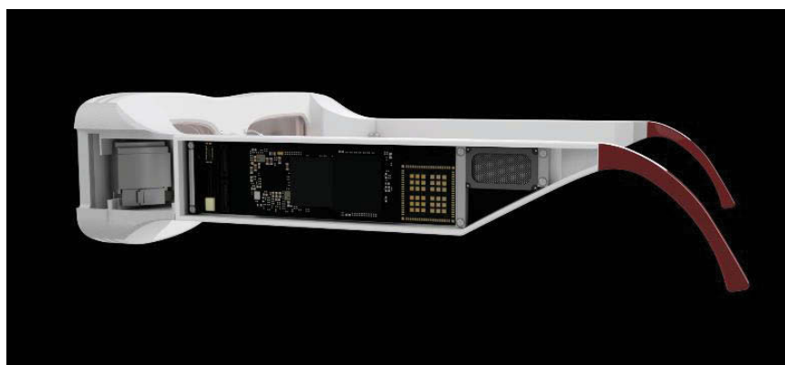
Рис. 2. Внутреннее устройство очков Vulcano Glasses
