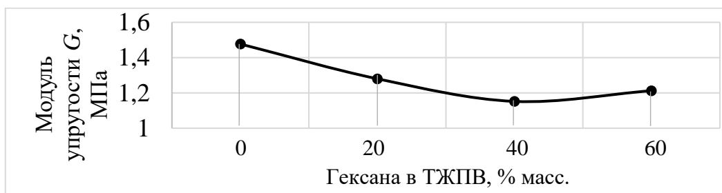
Рисунок 9 – Модуль упругости второго рода по ГОСТ 9550 – 81 полиамидных образцов различного состояния
