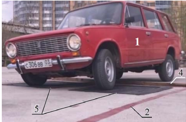
Рис. 7. Схема площадки и внешний вид дорожного контроля амортизаторов АТС: АБ – участок разгона; БВ – диагностический участок; ВГ – участок остановки АТС: 1 – автомобиль; 2 и 3 – границы коридора движения; 4 – единичная неровность с размерами сечения 0,05 \times 0,05 м; 5 – платформы, измеряющие нормальную R_z и продольную R_y реакции на колесах АТС
