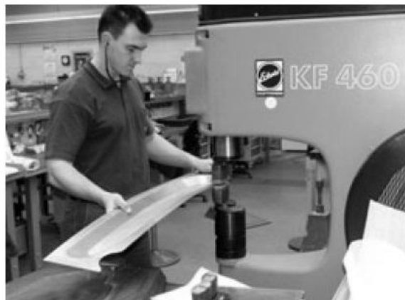
Рисунок 1.15 – Правка деталей местной посадкой (разводкой) полотна на прессе KF 460 фирмы Eskold AG [63]
