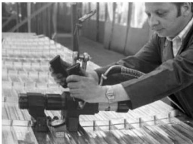
Рисунок 1.16 – Правка деталей местной посадкой (разводкой) полотна переносным инструментом Dornier Do 228 фирмы Eckold AG [63]
