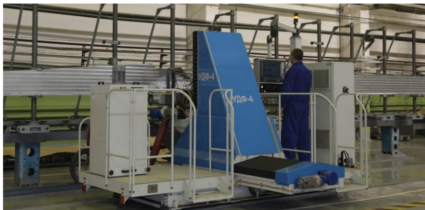
Рис. 9. Установка для дробеударного формообразования-зачистки УДФ-4
