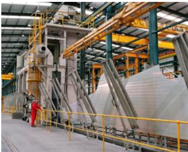
Рис. 3. Установки компании MIC для дробеударного формообразования (а) и упрочнения (б) панелей
