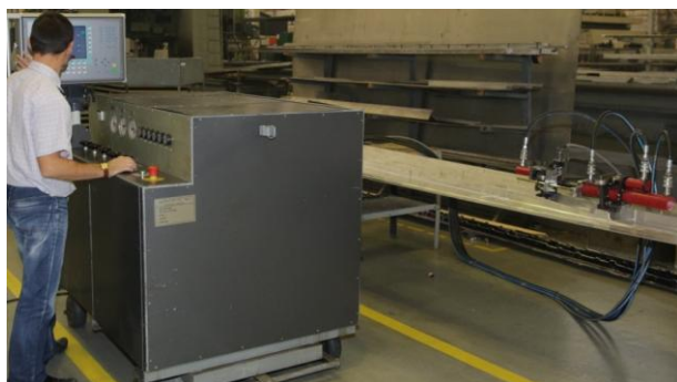
Рис. 12. Установка УМПД-2 для раскатки ребер монолитно-фрезерованных панелей
