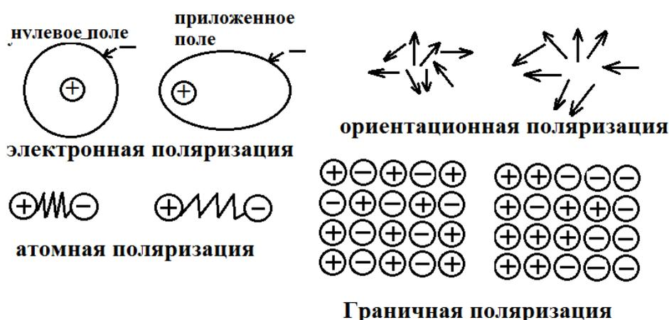
Рис. 1.1. Механизмы поляризации
