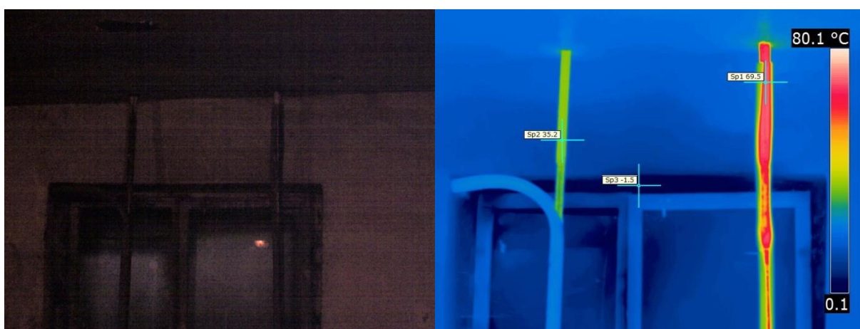
Фото и термо 28. Пример разности температур стояка (подача/обратка) при последовательной схеме подключения отопительных приборов – последний (седьмой) по порядку от элеватора.
