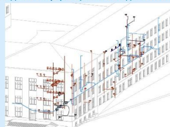
Моделирование инженерных сетей и расстановка санитарно-технического оборудования
