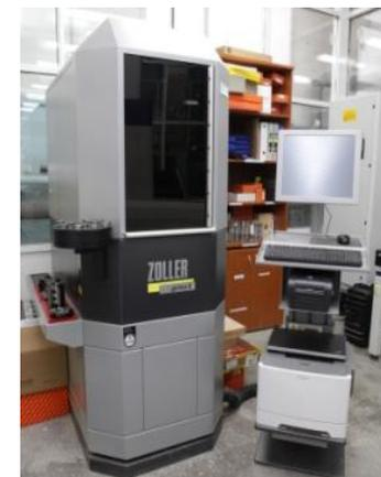
Прибор для измерения инструмента Zoller Genius III
