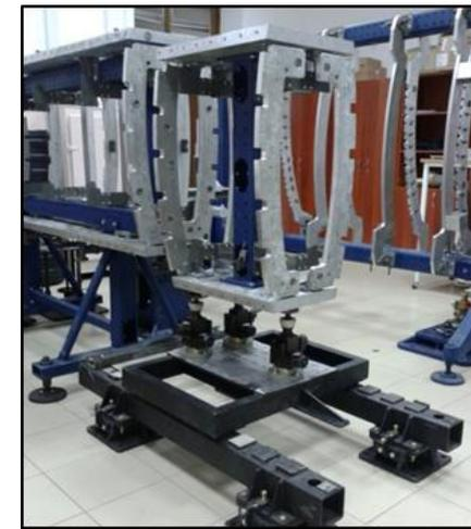
Лабораторные стелы для узловой и агрегатной сборки и стыковки изделий авиационной техники
