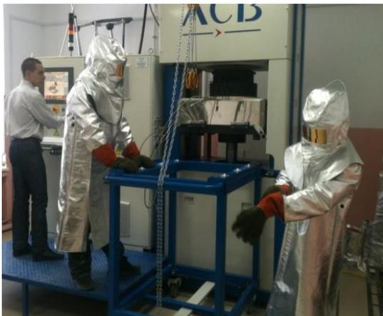
Пресс сверхпластичного формования/диффузионной сварки
