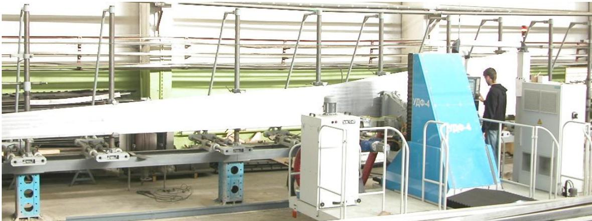
Установка дробеударного формообразования-зачистки с ЧПУ УДФ-4
