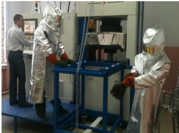
**Пресс сверхпластичного формования/диффузионной сварки**
