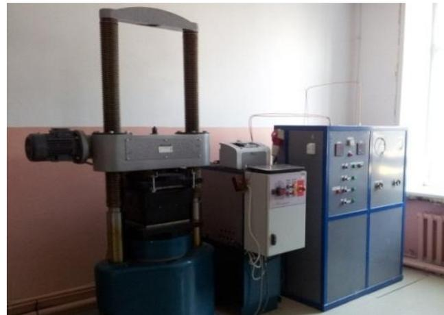
**Испытательный пресс ИП-1250м**
