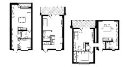
Рис. 2.8 Планировка квартир 1 модуля
