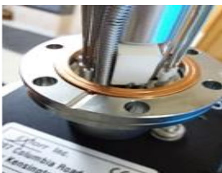
Уплотнительное кольцо, размещенное во фланце
