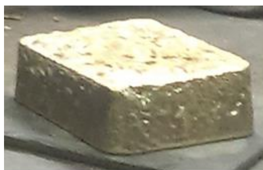
Слиток сплава золота лигатурного из катодных осадков после гидрохимической очистки из КО
